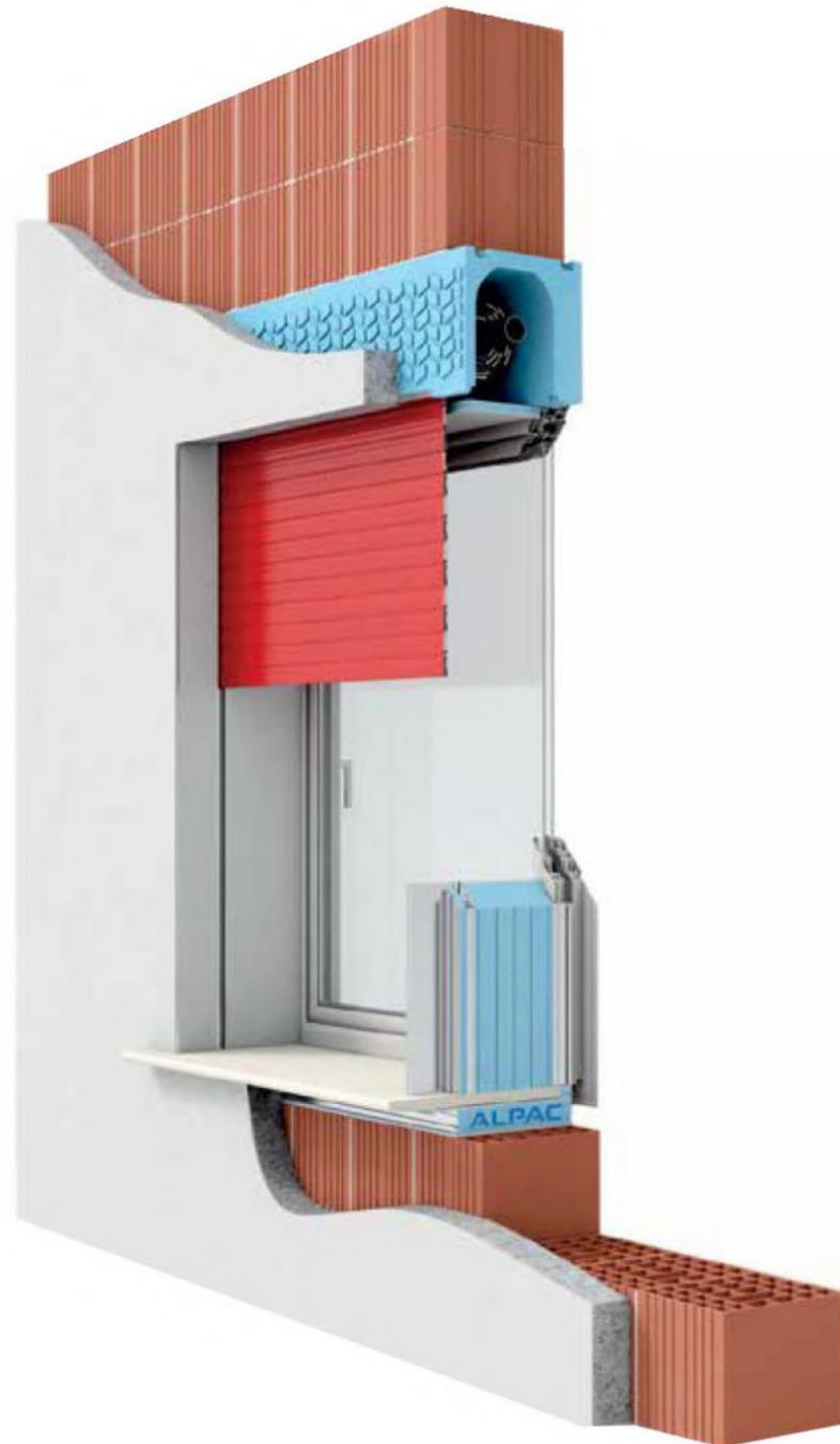
Il monoblocco PRESYSTEM® Avvolgibile consente di realizzare un foro finestra ad **alta efficienza energetica che massimizza la resa termica e acustica.**
